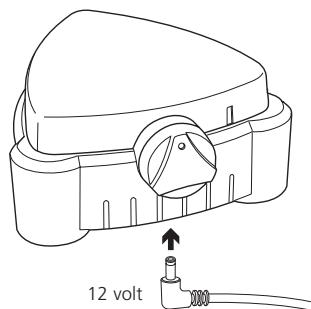
3. Seleccione el accesorio de enchufe correcto y conéctelo a la unidad de alimentación eléctrica tal y como se muestra a continuación. Conecte el enchufe de alimentación eléctrica a la toma de alimentación de red.
