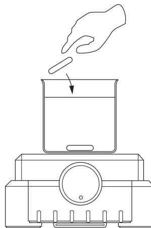
5. Ruotare la manopola di comando **in senso orario** per regolare la velocità dell'agitatore a una velocità compresa tra 300 e 2.000 giri/min.
