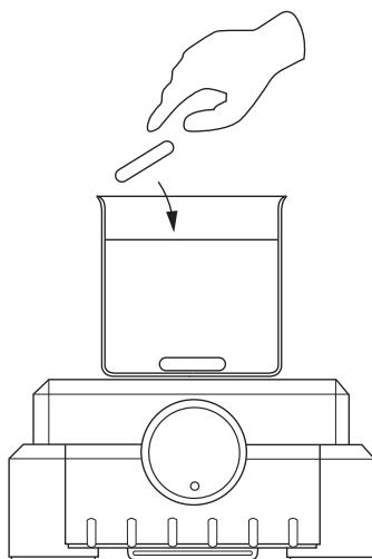
5. Drehen Sie den Regler **im Uhrzeigersinn**, um die Rührgeschwindigkeit zwischen 350 und 2.000 U/Min zu verstellen.
