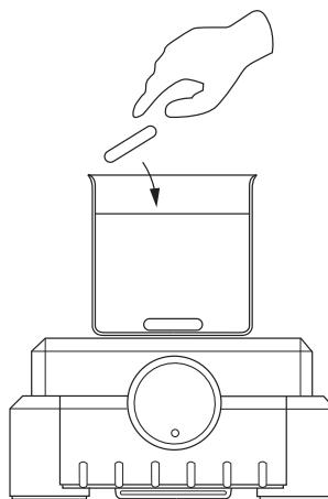
5. Gire el botón de control en sentido **horario** para ajustar la velocidad de agitación entre 350 y 2.000 rpm.
