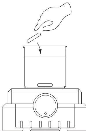
5. Tournez le bouton de **commande** dans le **sens des aiguilles d'une montre** pour régler la vitesse d'agitation entre 350 et 2000 tr/min.
