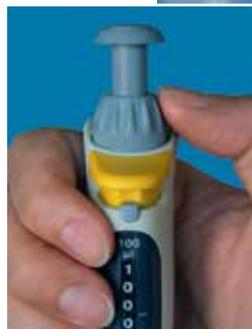
Changements visibles du réglage d'usine par marque du calibrage
