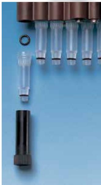
**Les tiges individuelles** avec leur joint respectif de pipette multicanaux Transferpette® S -8/-12 peuvent être simplement dévissées (breveté). Tige et joint sont maintenant faciles à nettoyer ou à remplacer. Réparations coûteuses et les longues périodes d'indisponibilité font partie du passé.
