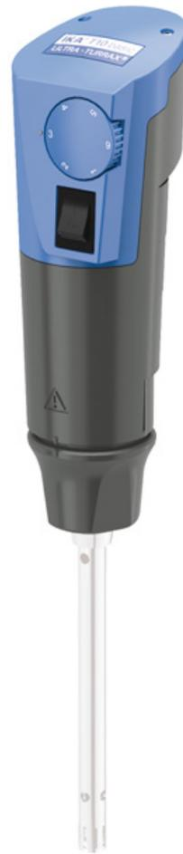
Petit instrument de dispersion pour des volumes compris entre 0.5 - 100 ml (H<sub>2</sub>O). Il offre une large plage de vitesses comprise entre 8000 – 30 000 tr/min, permettant aux utilisateurs de travailler à des vitesses périphériques élevées même avec des petits diamètres de rotor. Un grand choix d'outils de dispersion garantit une gamme étendue d'applications.
