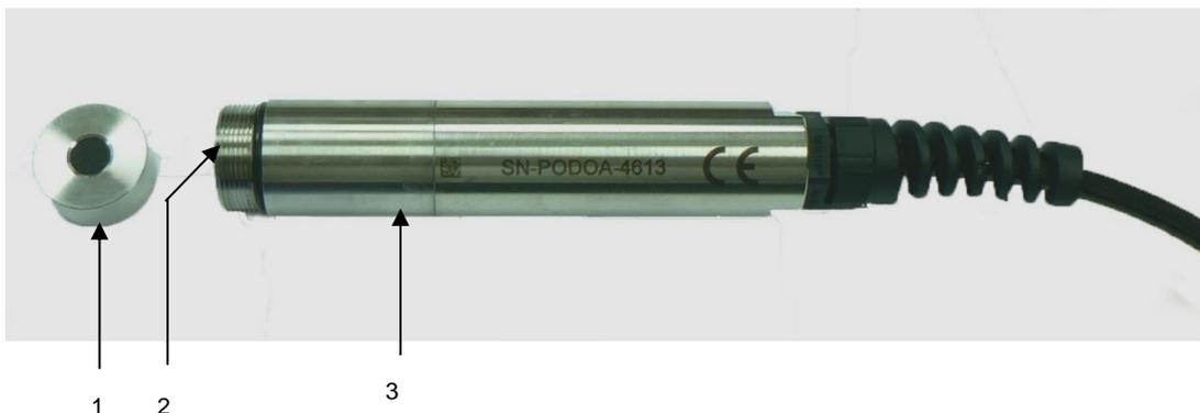
**1** Dévisser le DODISK (1), en Inox ou Titane, du corps du capteur avec l'électronique de mesure (3). Assurez-vous que la fenêtre optique (2) du capteur soit bien propre et sans présence d'eau ou d'humidité.
