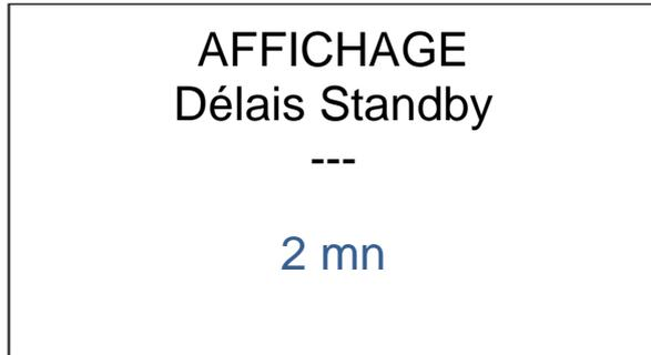
Par défaut le délai avant activation du standby est de 2 minutes et il peut être paramétré selon les timings suivants : 2, 5, 15 ou 30 minutes.
