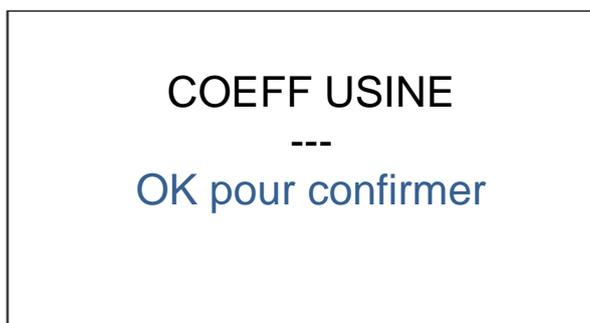
Pour valider l'envoi des coefficients usine dans le capteur valider avec la touche OK puis appuyer sur Escape (ESC) pour revenir à l'écran précédant.
