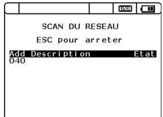
Si l'ODEON ne détecte pas de capteur ou que le SCAN a été stoppé avant que l'adresse des capteurs connectés ne soit détectée, le message suivant apparaît.
