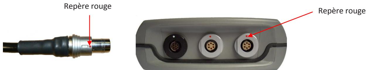
Pour la connexion, positionner le repère rouge du connecteur du capteur face au repère rouge du connecteur du boîtier ODEON. Lorsque le capteur est correctement positionné, vous devez entendre un clic.
