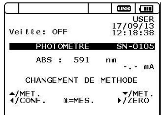
Lors de la connexion d'un PHOTOPOD, si la flèche du HAUT est sélectionnée le message «DEBUT LISTE DES METHODES» apparaît. Pour actionner le défilement des méthodes, il faudra appuyer sur la flèche du bas.
