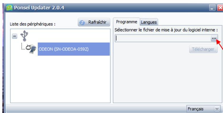
Dès que l'ODEON est sélectionné, un onglet apparaît sur la partie droite de la fenêtre et permet de charger un nouveau logiciel interne (onglet Programme) ou des fichiers langues (Onglet Langues).
