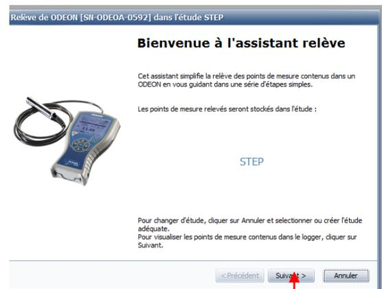
Dans la fenêtre suivante, il est possible de visualiser les points de mesure présents dans l'ODEON ainsi que le détail des capteurs/paramètres du point de mesure.
