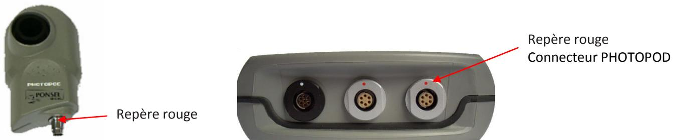
Lorsque le PHOTOPOD est connecté, il reste le connecteur du milieu qui peut recevoir un capteur numérique, un câble Y permettant de connecter 2 capteurs, un TRIPOD (sonde numérique multiparamètres)..
