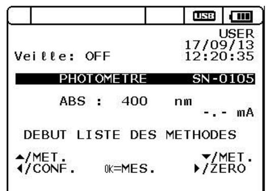
Lorsqu'on arrive à la fin du listing des méthodes, le message «FIN LISTE DES ANALYSES» apparaîtra lors d'un appui sur la touche Bas
