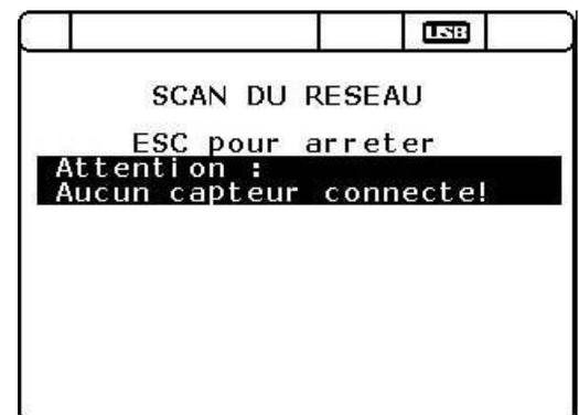
Lorsqu'un capteur actif est identifié, une nouvelle ligne apparaît avec son adresse et sa description. Lorsque l'ensemble des capteurs connectés ont été identifiés, l'opérateur peut interrompre le SCAN avec ESC.
