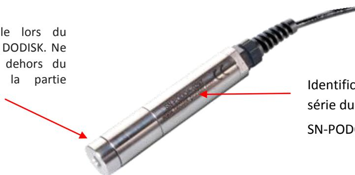
Identification capteur avec N° de série du type :
