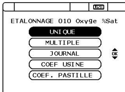
L'étalonnage du capteur oxygène peut être effectué en 2 étapes, via le menu de l'étalonnage complet, ou 1 seule via l'ajustement de la pente.
