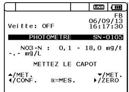
Si la concentration de l'échantillon mesuré est inférieure à celle proposée par la méthode sélectionnée, le message « HORS GAMME » apparaît.
