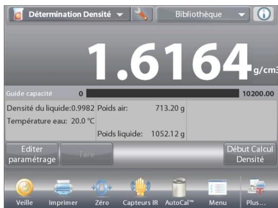
**Étape 1 sur 2 - Pesée de l'échantillon dans l'air.**
