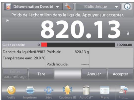
**Étape 2 sur 2 - Pesée de l'échantillon submergé dans un liquide.**
