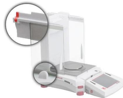
Positionner la porte en verre pour qu'elle coulisse. Ouvrir la languette de verrouillage (supérieure) ; insérer dans la rainure supérieure et faire coulisser au fond de la rainure inférieure. Fermer la languette de verrouillage.
