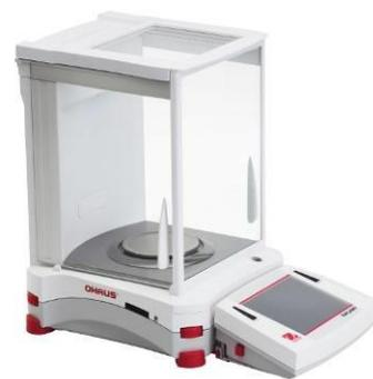
Insérer les extrémités des crochets de la porte supérieure dans les ancrages rainurés. Appuyer légèrement pour bien les placer. Vérifier la facilité du déplacement. Fermer la porte.
