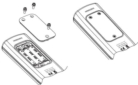
Remplacez les trois piles alcalines AAA de 1,5 V situées dans le compartiment à piles, en respectant la polarité indiquée dans le fond du boîtier.
