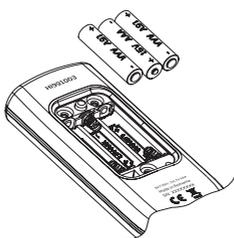
Remettez le couvercle du compartiment à piles en vous assurant que le joint d'étanchéité est en place.
