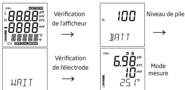
*Note : L'instrument détecte la présence et le type de sonde à son entrée.*
