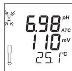
L'afficheur indique la valeur pH (compensée automatiquement en température) sur l'afficheur principal, tandis que l'afficheur secondaire indique la température de l'échantillon.
