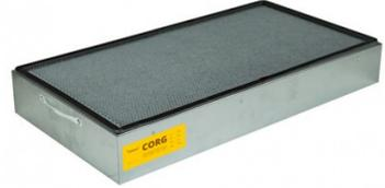
Il est impératif de contrôler et remplacer les filtres à charbon toutes les 60 heures (norme NFX15-211). Portez des gants et un masque adaptés pour effectuer cette opération.
