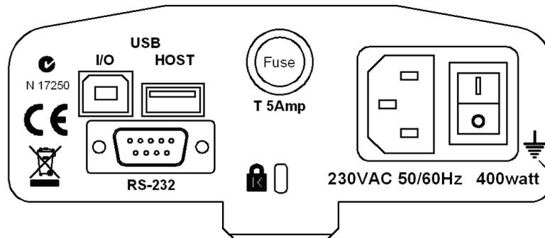
Le panneau arrière dispose de connecteurs pour l'interface de données, le porte fusible, le point d'attache antiviol et l'alimentation d'entrée.
