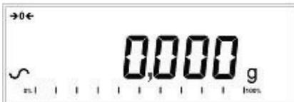
Un symbole de stabilité  $\sim$  est affiché lorsque l'analyseur est stable. Il disparaîtra si l'analyseur n'est pas stable. Le zéro exact est affiché quand le symbole "**→0←**" est allumé sur la gauche de l'écran.
