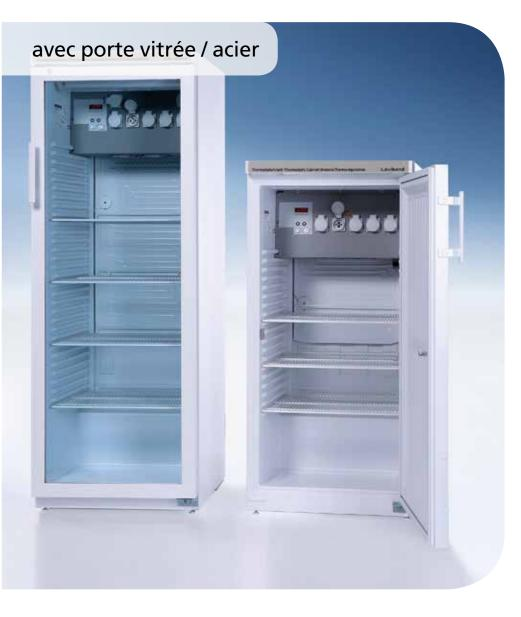
Les étuves thermostatées servent au tempérage continu dans la plage des températures 2 °C à 40 °C. Il en résulte une grande multitude d'applications dans les laboratoires des secteurs industriels et de la recherche.
